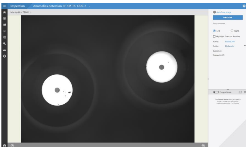
Изображение торцевых поверхностей феррул ODC-2 соединителя, полученное с помощью Manta-W+
